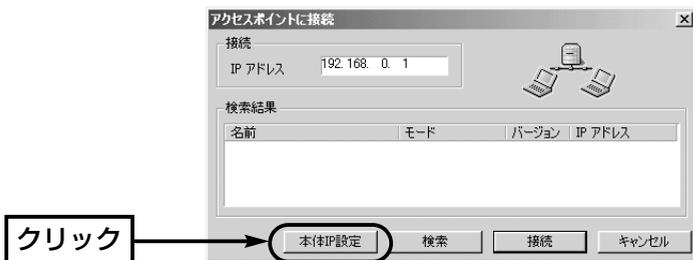
4. IPアドレス欄には、パソコンのIPアドレスと同じネットワーク部(※P19)になるように本製品のIPアドレスを入力します。
